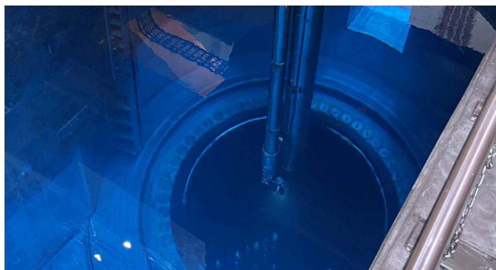
Zavážení paliva do reaktoru probíhalo pod vodou pomocí dálkově ovládaného stroje [2]
